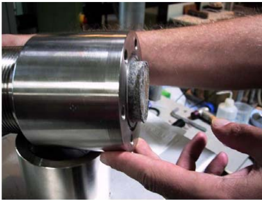
Abb. 3-17: 4. Schritt Ausdrücken der Probe nachdem das „Los-Brech-Moment“ bestimmt wurde.
