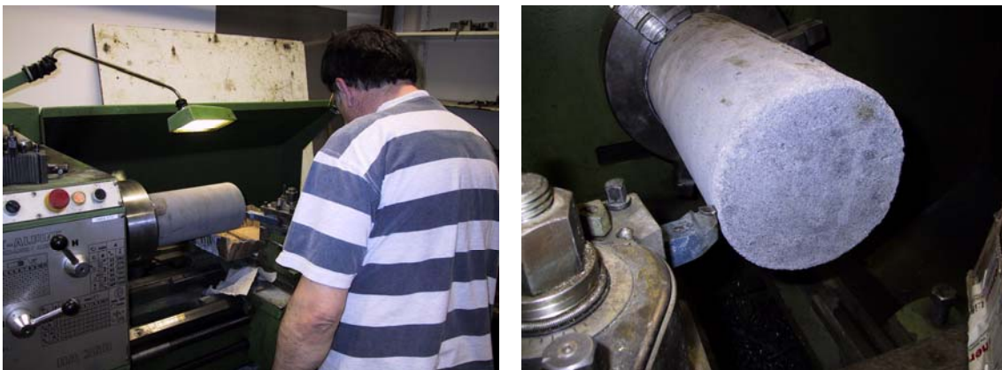
Abb. 3-33 Die Präparation der Prüfkörper erfolgte auf der Drehbank (Foto links). Der Durchmesser wird durch Abdrehen der Länge der angelieferten Probe angepasst (Foto rechts).
