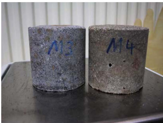
Abb. 3-20: 7. Schritt; Vorbereitung der Prüfkörper für nachfolgende Untersuchungen.
