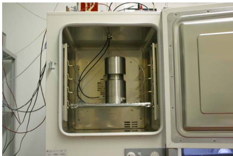
Abb. 3-13 Konfigurierte OEDOMETER-Zelle im Wärmeschrank.
