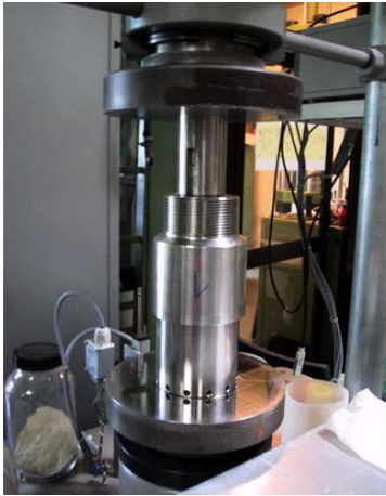
Abb. 3-14: 1. Schritt; Einrichtung der Presse und der Steuerung, die zum Ausbau „Punsch-Test“ der Prüfkörper eingesetzt wurde.
