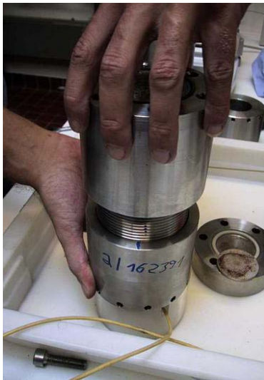
Abb. 3-15: 2. Schritt; Lösen der obere Verschraubung der Messzelle.
