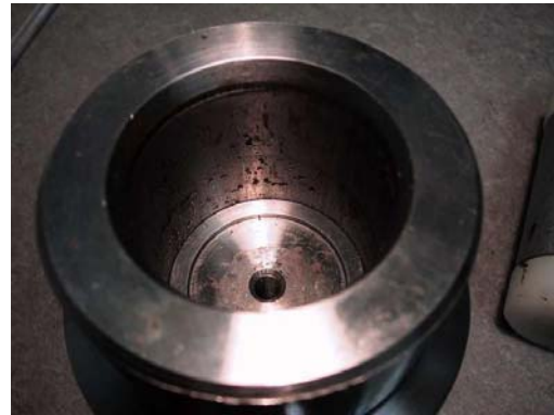
Abb. 3-19: 6. Schritt; Oben - Kontrolle der Funktionsfähigkeit der Systeme. Unten - Feststellung von Besonderheiten (Feuchtfilm , Korrosion).
