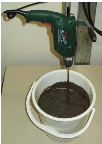
Abb. 3-6: (links) Anmischen / Homogenisieren der Komponenten und Lösung zu Suspensionen. (rechts) Die fließfähige Salzmischung wird zur Prüfkörperherstellung in Formen gegossen (Fotos DBE). Im Anschluss werden die fertigen Materialmischung über zwei Minuten auf dem Rütteltisch verdichtet bzw. die Luftblasen entfernt.
