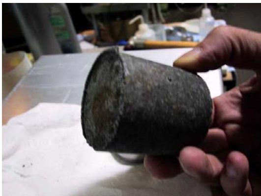
Abb. 3-18: 5. Schritt; Bemusterung des gesamten Prüfkörpers und Ermittlung der Ausbaudichte.
