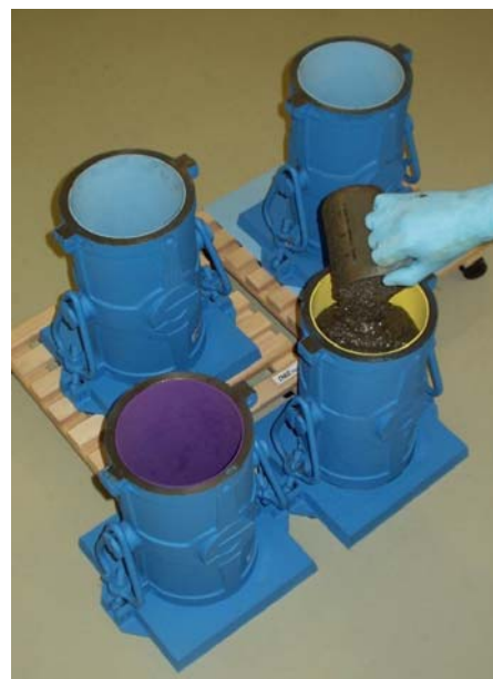
Abb. 3-6: (links) Anmischen / Homogenisieren der Komponenten und Lösung zu Suspensionen. (rechts) Die fließfähige Salzmischung wird zur Prüfkörperherstellung in Formen gegossen (Fotos DBE). Im Anschluss werden die fertigen Materialmischung über zwei Minuten auf dem Rütteltisch verdichtet bzw. die Luftblasen entfernt.
