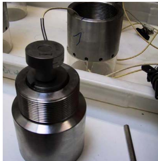
Abb. 3-15: 2. Schritt; Lösen der obere Verschraubung der Messzelle.
