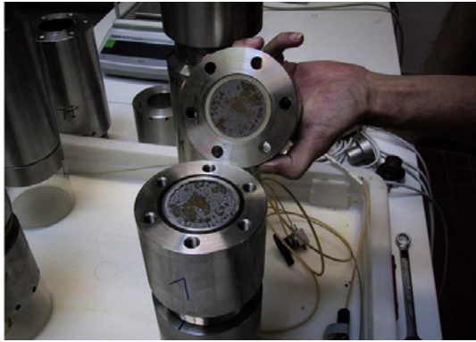
Abb. 3-16: 3. Schritt; Bemusterung der Stirnfäche des Prüfkörpers hinsichtlich Schrumpfungerscheinungen; danach Ermittlung des „Los-Brech-Momentes“.
