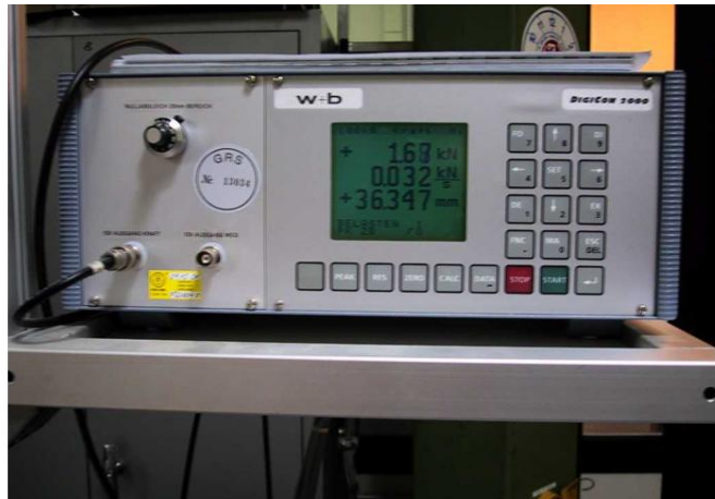
Abb. 3-14: 1. Schritt; Einrichtung der Presse und der Steuerung, die zum Ausbau „Punsch-Test“ der Prüfkörper eingesetzt wurde.
