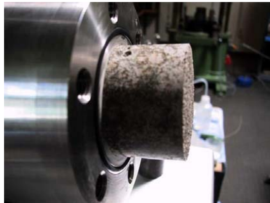
Abb. 3-17: 4. Schritt Ausdrücken der Probe nachdem das „Los-Brech-Moment“ bestimmt wurde.
