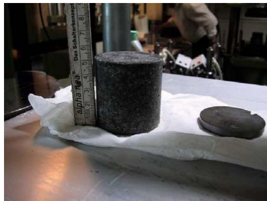
Abb. 3-18: 5. Schritt; Bemusterung des gesamten Prüfkörpers und Ermittlung der Ausbaudichte.
