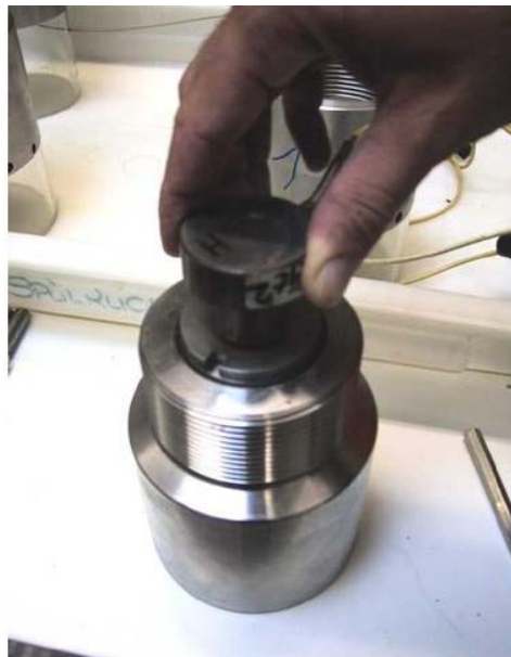
Abb. 3-12: Verfahren II; Position des Kraftaufnehmers in der Messzelle ( F ). Der Sensor ( C ) wird auf der gehärteten Platte ( D ) auf dem Kolben ( E ) positioniert, der direkten Kontakt zum Material hat.
